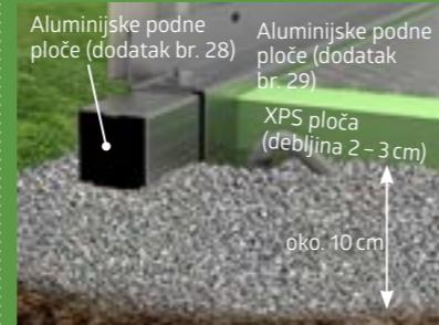
Uz **aluminijski podni okvir** možete postaviti i podne kopče i usidriti ostavu na šljunčanoj podlozi (podna sidra dostupna kao dodatna oprema). **Aluminijске podne ploče** služe kao funkcionalan pod i podstavljeni su XPS pločama od tvrde pjene koje nisu uključene u isporuku).
