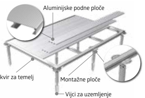
**Vrijeme montaže:** 2 – 4 sata za dvoje (ovisno o vještini i proizvodu). **Alat:** bušilica s čekićem, svrdlo Ø 40 x 570 mm, libela, bušilica, ključ SW13 i SW24, lopata.
