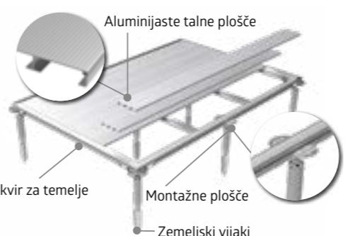
**Čas montaže:** 2 – 4 uri za dva (odvisno od spremnosti in izdelek). **Orodja:** udarni vrtalnik, sveder Ø 40 x 570 mm, vodna tehtnica, vrtalnik, viličasti ključ SW13 in SW24, lopata.
