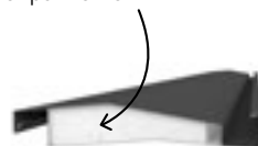
Lamelstruktur Sandwichkonstruktion med Peripor-kerne.
