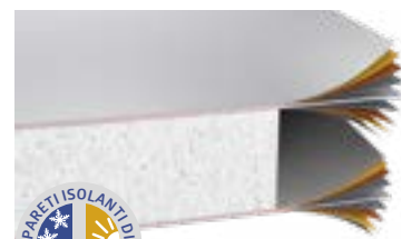
Pareti laterali isolate / elemento porta Elemento sandwich con anima di 40 mm in polistirolo (EPS W20)
