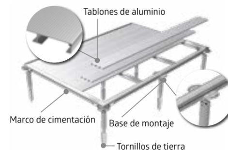
**Tiempo de montaje:** 2 a 4 horas para dos personas (dependiendo de la mano de obra y del producto). **Herramientas requeridas:** martillo perforador, broca Ø 40 x 570 mm, nivel de burbuja, taladro, llave de boca SW13 y SW24, pala.
